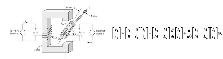
Total power  $v_1 i_1 + v_2 i_2 = \begin{bmatrix} i_1 & i_2 \end{bmatrix} \begin{bmatrix} v_1 \\ v_2 \end{bmatrix}$
