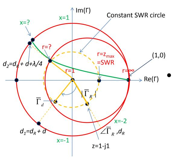
$$:: \overline{Z}(d) \bullet \overline{Z}(d + \lambda / 4) = \overline{Z}_0^2$$
