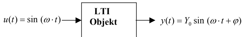
Bild 2.2.1 Erregung eines LTI Objekt durch harmonisches Signal
