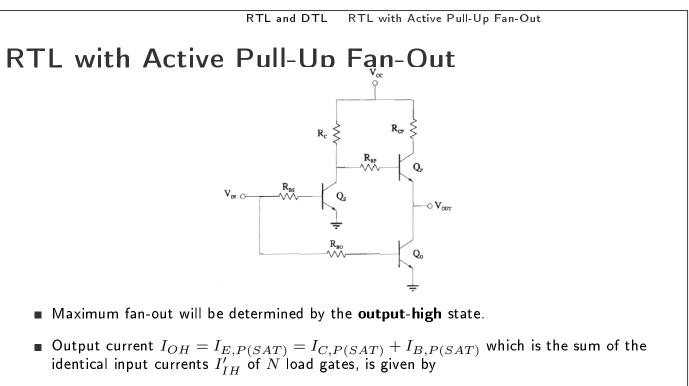
$$I_{OH} = \frac{V_{CC} - V_{CE,P(SAT)} - V_{OH}}{R_{CP}} + \frac{V_{CC} - V_{BE,P(SAT)} - V_{OH}}{R_{C} + R_{BP}} = NI'_{IH}$$
